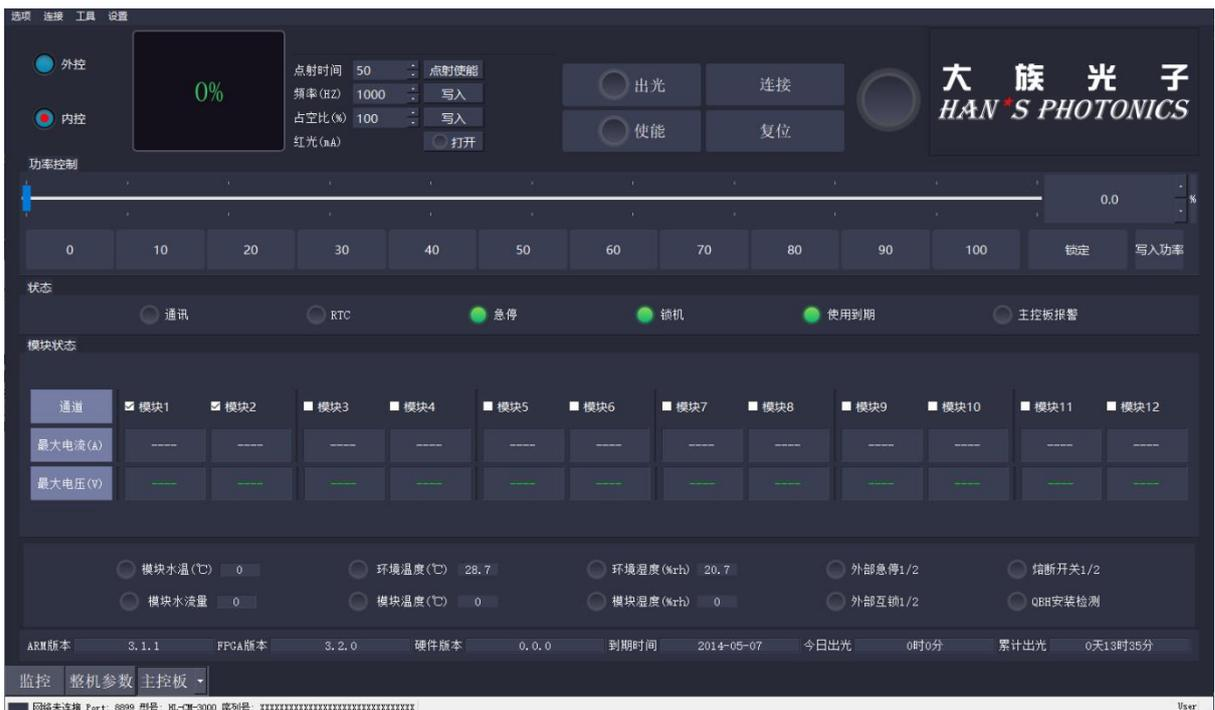
2、对装有操作界面的本地电脑需要进行如下设置：IP地址：192.168.0.xxx（xxx不能设置为激光器的IP地址）；子码掩码：255.255.255.0；默认网关：192.168.0.1
