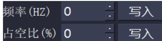
在调制频率的单行框中填入合适的频率，再点击 **写入** 按钮，就将需要的频率写入到激光器中，同样，在占空比的单行框中填入合适的占空比值，再点击 **写入** 按钮，就将需要的占空比写入到了激光器中。
